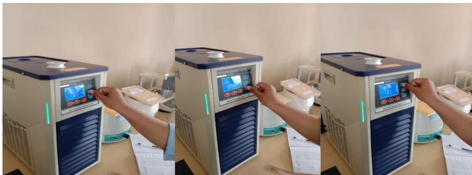
Pengaturan Chiller Pada Alat Rotary Evaporator
