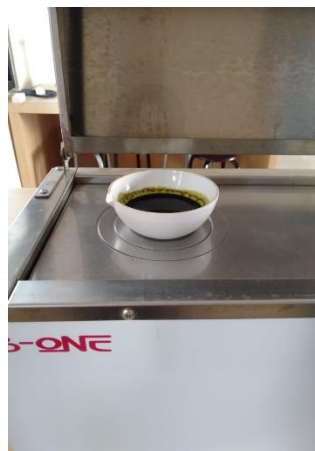
Proses pengentalan ekstrak dengan watwrbath
