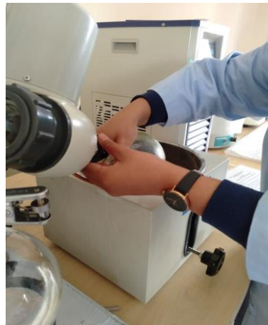
Proses pengentalan ekstrak dengan rotary evaporator
