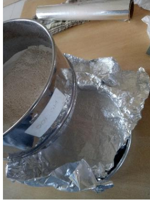
Bahan Yang Sudah Digerus Diayak Di Ayakan Mesh 60 Diayak Lagi Di Ayakan Mesh 100
