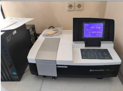
Pegujian menggunakan spektrofotometer UV-Vis
