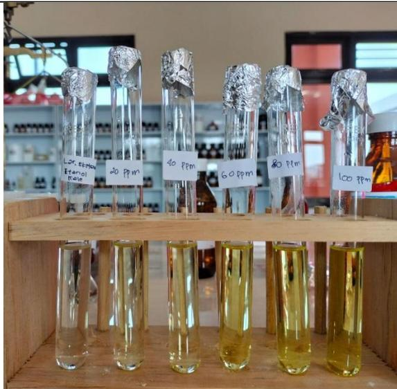
Larutan Sampel ekstrak etanol daun kale dan larutan seri standar kuersetin yang telah ditambahkan  $\text{AlCl}_3$  10% asam asetat 5%, etanol 96% dan aquadest untuk diuji di spektrofotometer UV Vis
