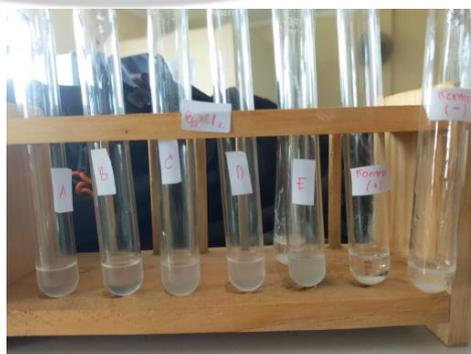
**Gambar 4. 2** Hasil Uji dengan Larutan  $BaCl_2$
